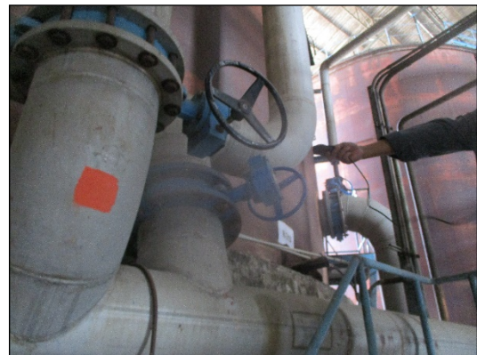
ภาพที่ 3.8-1 แสดงตัวอย่างการตรวจวัดระดับความเข้มแสงสว่าง
