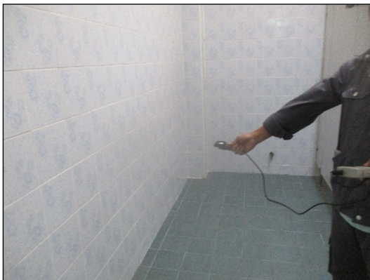
ภาพที่ 3.8-1 แสดงตัวอย่างการตรวจวัดระดับความเข้มแสงสว่าง
